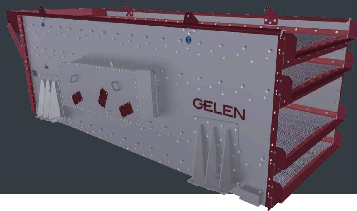
Виброгрохот эллиптического движения серии ETE осуществляет горизонтальное просеивание, при помощи тройного вала выполняет эллиптическое движение, которое в свою очередь является самым эффективным методом просеивания в индустрии. Способность к изменению формы и угла движения эллипса позволяет наилучшим образом использовать скальпель и грохот. Данный вид грохота позволяет проводить просеивание влажных материалов, также устанавливать промывающие системы.
